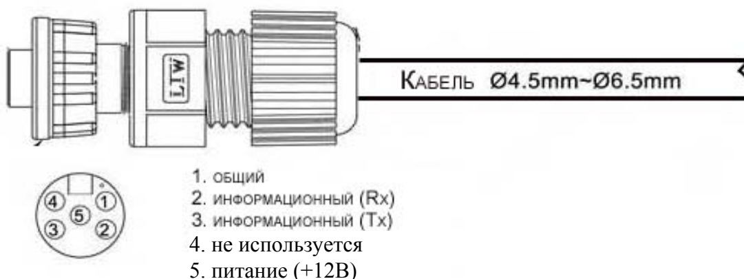
Рис. 7 Схема внешних соединений для организации связи по RS232.
